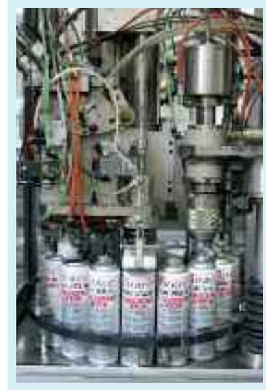
iBiotec est l'inventeur d'un procédé exclusif de mise sous pression de boîtiers aérosols par impact gazing associé à la technique gazer-shaker. Brevet **904 0 1968.4**. Ce procédé permet d'utiliser un propulseur d'origine naturelle, inerte, ininflammable, incombustible, alimentaire, pharmaceutique, médical, bactériostatique et d'une disponibilité illimitée.
