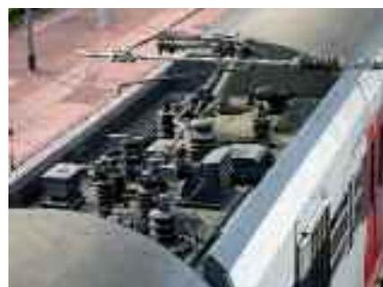
Lubrification dynamique, sous HT, de pantographes
