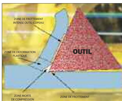
L'usure outil découle des sollicitations mécaniques très sévères à l'interface copeau-outil et outil-pièce, accentuée par les effets thermiques.
