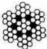
Tous les câbles, qu'ils soient destinés au tirage, au levage, à l'extraction, à la traction, y compris au transport des personnes, sont soumis à de nombreuses contraintes et de nombreux microcontacts surfaciques. Etirement du métal, phénomènes vibratoires, oscillations, torsions, frottements et chocs.
