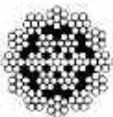
En multipliant le nombre de torons, on diminue les surfaces de contact avec les poulies ou les tambours. Les câbles anti-giratoires limitent les problèmes de torsion.
