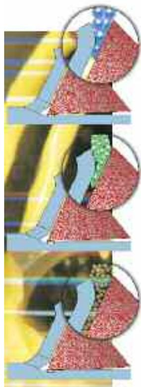
L'encombrement moléculaire des émulsions ne permet pas une pénétration suffisante dans l'espace outil-copeau.
